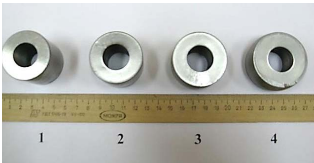
Рис. 3. Фотография осажённых колец с r_0 = 8 мм, \alpha = 0,40 : 1 – \varepsilon = 0 ; 2 – \varepsilon = 0,15 ; 3 – \varepsilon = 0,3 ; 4 – \varepsilon = 0,4
